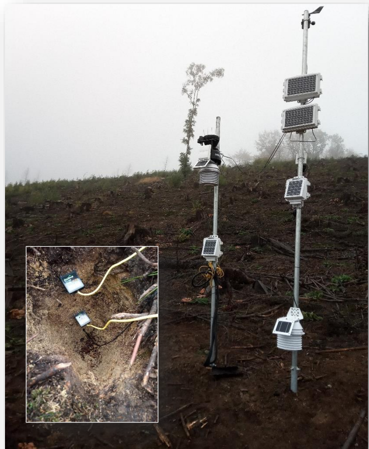
Abb. 4: Klimamessstation auf Kahlfäche. Im kleinen Bild sind die Bodensensoren zu sehen.
